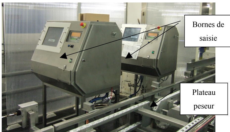
Illustration 7. Bornes de pesée intégrées au convoyeur. Lorient (16/11/06)
